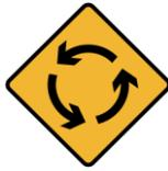
**GLORIETA:** Indica a los conductores de vehículos la proximidad de una intersección de dos o más vías a nivel, con una isla central en forma circular u ovalada.
