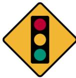
**SEMÁFORO:** Indica a los conductores de vehículos la proximidad de una intersección controlada por semáforos en una vía donde no se espera encontrarlos, o en un cruce donde no sea visible desde una distancia suficiente para reducir la velocidad y detenerse.
