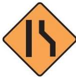
**REDUCCIÓN DE LA VÍA:** Indica a los conductores de vehículos la proximidad de un estrechamiento de la vía, asimétrica o simétrica, debido a una ocupación temporal de la misma.
