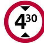
**ALTURA PERMITIDA:** Indica a los conductores de vehículos de grandes dimensiones, la altura libre de un elemento o estructura que limita su tránsito.
