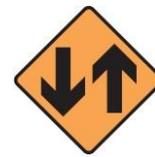
**DOBLE SENTIDO DE TRÁNSITO:** Indica a los conductores de vehículos que circulan en un tramo de un solo sentido, la proximidad de un tramo de circulación en ambos sentidos.
