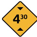
**ALTURA LIMITADA:** Indica a los conductores de vehículos la proximidad de una altura libre que puede verse limitada por un elemento o estructura, y afectar a ciertos vehículos.
