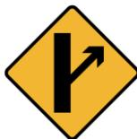
**SALIDA:** Indica a los conductores de vehículos la proximidad de una desincorporación de la vía. El pictograma puede incluir información sobre la velocidad conveniente a la que se debe realizar el movimiento de salida.
