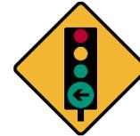
**VUELTA IZQUIERDA CON SEMÁFORO:** Indica a los conductores de vehículos la proximidad de una intersección controlada por semáforos, en la cual la vuelta izquierda sólo es posible cuando la señal luminosa con flecha direccional se encuentre en verde.
