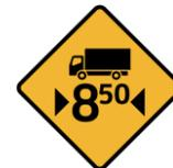
**LONGITUD LIMITADA:** Indica a los conductores la proximidad de una vía donde existen curvas horizontales o verticales pronunciadas, en las que no es posible el tránsito de vehículos que excedan la dimensión indicada en la señal.
