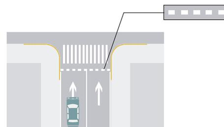
**RAYA DE ALTO:** Indica a los conductores de vehículos el lugar en el que deben detenerse debido a una señal de alto, semáforo o punto de control en el camino.
