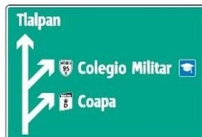
**DIAGRAMÁTICA:** Indica a los conductores de vehículos, mediante un esquema, los puntos de decisión en una intersección.
