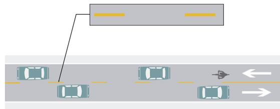
**RAYA SEPARADORA DE SENTIDOS DE CIRCULACIÓN DISCONTINUA SENCILLA:** Indica a los usuarios la separación de los sentidos de circulación vehicular, en vías en las que se permite el rebase utilizando el carril en sentido contrario.
