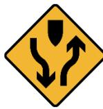
**SEPARADOR O ISLA:** Indica a los conductores de vehículos la proximidad del inicio o final de una faja separadora central, isla u obstáculo fijo o temporal, el cual divide una vía en uno o dos sentidos de circulación.
