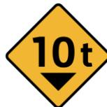
**PESO LIMITADO:** Indica a los conductores de vehículos la proximidad de una vía o puente en los cuales sólo se permite el tránsito de vehículos cuyo peso bruto total no exceda aquel indicado en la señal.
