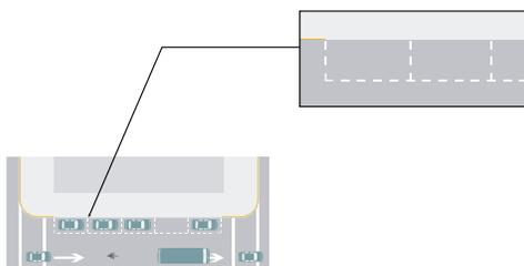
**ESTACIONAMIENTO EN ZONAS DE PARQUÍMETROS:** Indica a los usuarios la presencia de espacios para estacionamiento, en zonas con cobro en vía pública. El usuario debe hacer uso de un solo cajón para estacionar su vehículo.
