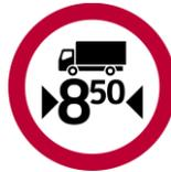
**LONGITUD PERMITIDA:** Indica a los conductores de vehículos de grandes dimensiones la restricción de longitud, en una vía en la cual existen curvas horizontales con un radio de giro limitado, o curvas verticales cortas y pronunciadas.
