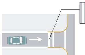
**RAYA GUÍA EN INTERSECCIÓN:** Indica a los conductores de vehículos la trayectoria que deben seguir, en intersecciones que, por su diseño o condiciones de visibilidad, no son predecibles.
