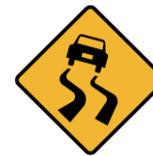
**SUPERFICIE DERRAPANTE:** Indica a los conductores de vehículos la proximidad de un tramo de pavimento resbaloso por presencia de material suelto, agua o hielo.
